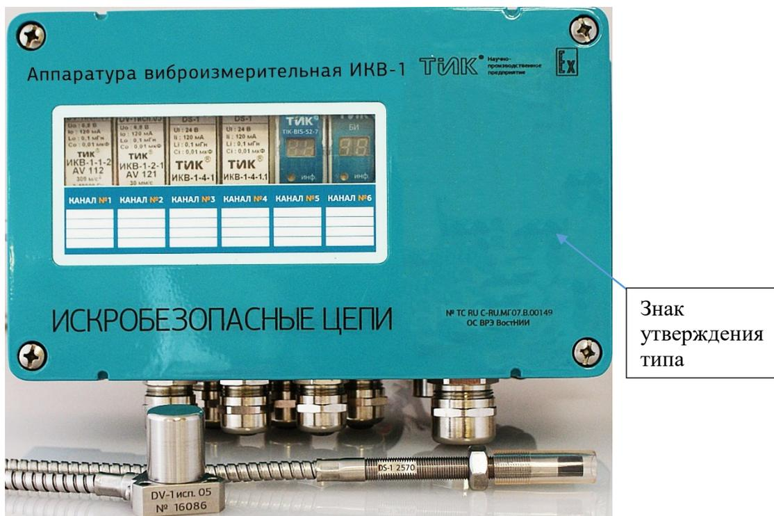
Рисунок 1 - Общий вид аппаратуры виброизмерительной ИКВ-1
