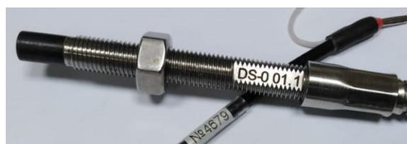
Рисунок 2 – Общий вид вихретоковых преобразователей DS-0, DS-1, DS-2, DS-3
